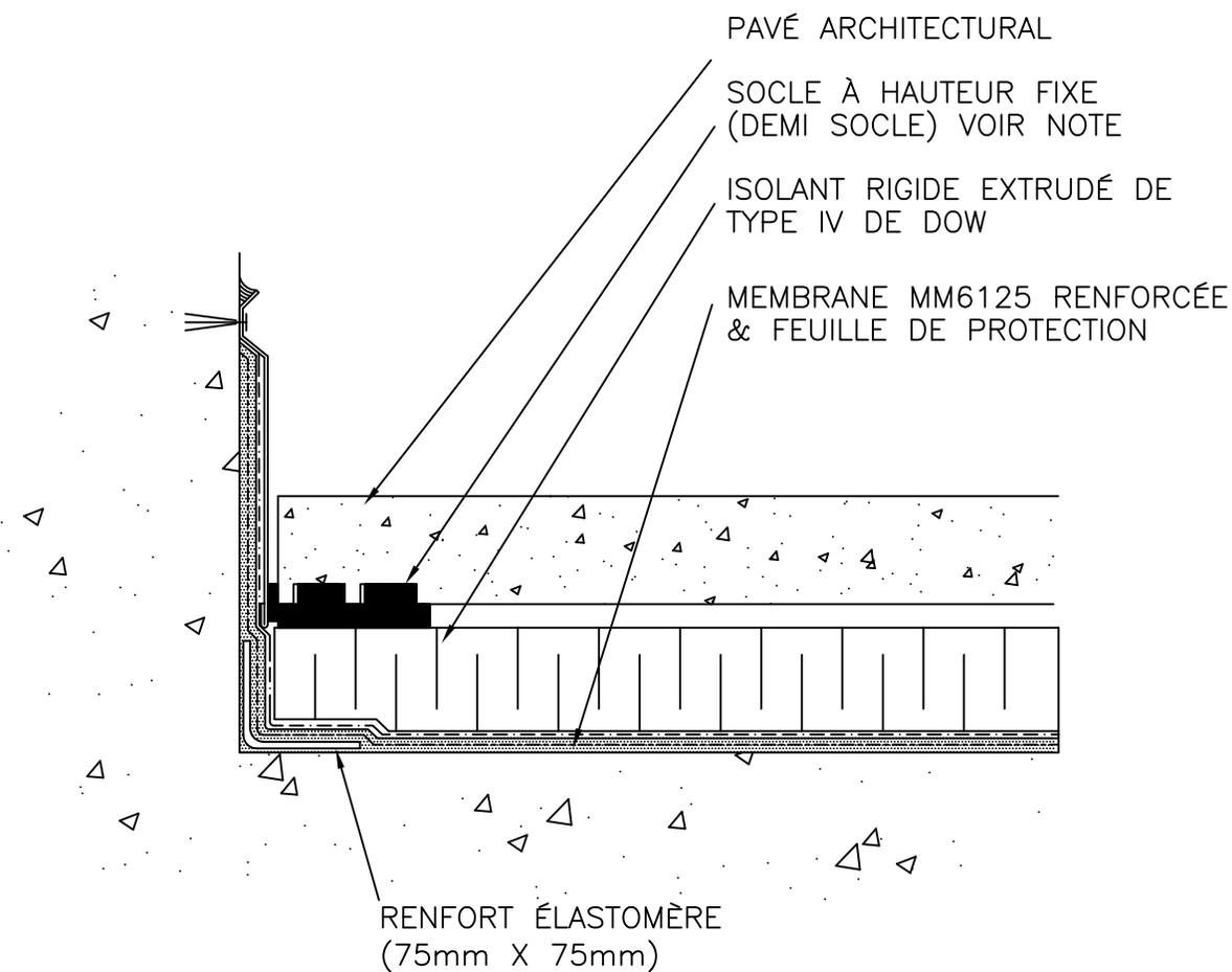
NOTES: L'ISOLANT RIGIDE DE TYPE IV DOIT ÊTRE UN H1-60 À MOINS D'AVIS CONTRAIRE DU MANUFACTURIER.
