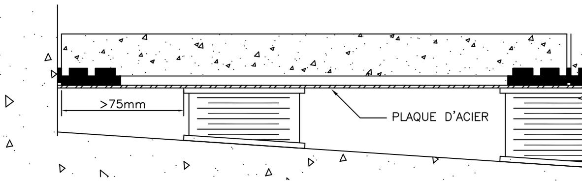
NOTES: LORSQUE LE DERNIER PAVÉ DOIT ÊTRE EN PORTE-À-FAUX SUPÉRIEUR À 75mm, UNE PLAQUE D'ACIER INOXYDABLE OU GALVANISÉE (AU QC, AVEC LE CALCIUM L'ACIER ORDINAIRE VA S'OXYDER), 125 X 660 X 9,5 mm, DOIT ÊTRE DÉPOSÉE COMME PASSERELLE ENTRE LES DEUX DERNIERS SOCLES AJUSTABLES. LES SOCLES À HAUTEUR FIXE SONT ENSUITE PLACÉS SUR LE DESSUS DE LA PLAQUE D'ACIER POUR SOUTENIR ET ESPACER LE PAVÉ.
